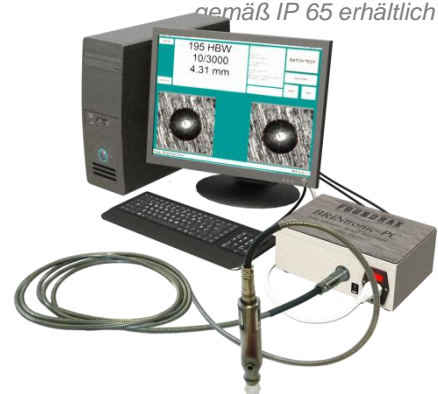
BRINtronic-MD: vollautomatisches Brinell-Mikroskop für die Verwendung mit dem kundeneigenen PC/Laptop (auch als BRINtronic-MDb mit Akku erhältlich, so dass er für den portablen Einsatz geeignet ist).
